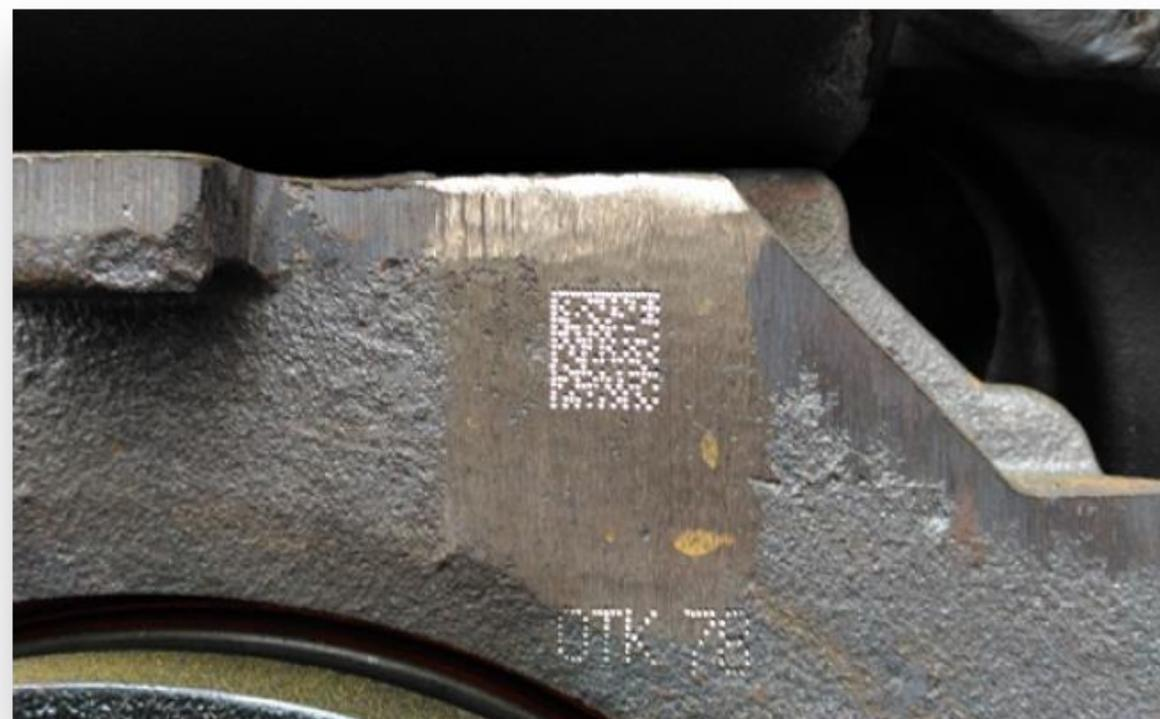
*Пример нанесения маркировки ударно-точечным способом*
