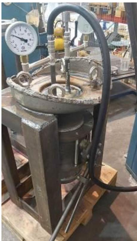
Рис 3. Опытный образец затвора универсального сливного прибора в испытательной оснастке
