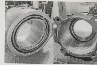
Рисунок 1 – Корпус буксового узла до обмывки
