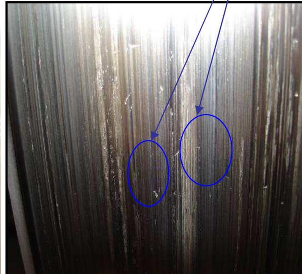
Поверхность катания колеса после применения тормозной колодки ФРИТЕКС Контакт® (фото 8)
