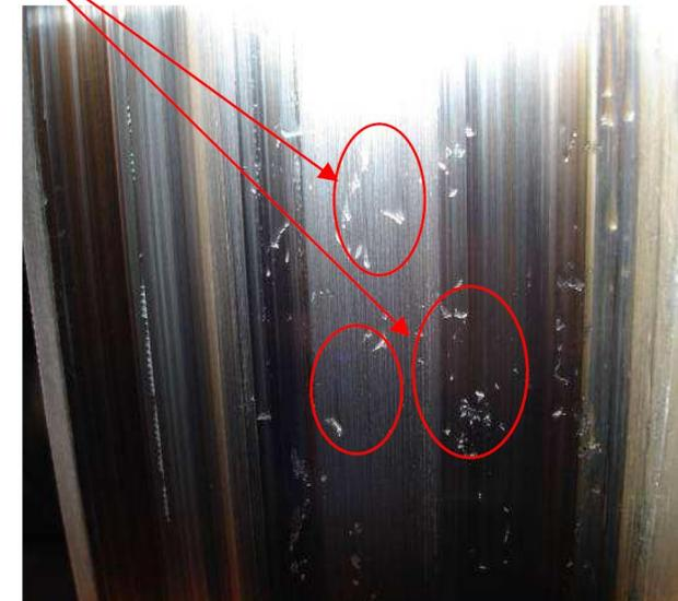
Поверхность катания колеса до применения тормозной колодки ФРИТЕКС Контакт® (фото 7)
